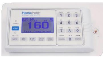
Le **SIGNATURE ELITE** émet un « **beep** » et **affiche le résultat final**, le message « **test terminé** » apparaît. Le résultat reste affiché 5 minutes à l'écran ou jusqu'à ce que la cuvette soit retirée.
