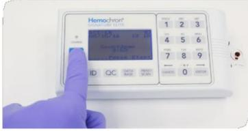
**Ajouter** l'échantillon et **appuyer** sur « **START** ». Le test démarre.
