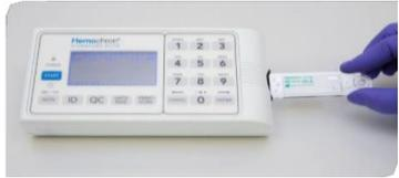
**Insérer** la cuvette à **température ambiante** doucement dans la fente et jusqu'à ce que vous entendiez un « **Click** ».
