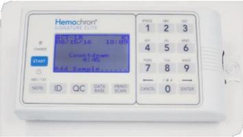
**SIGNATURE ELITE** indiquera sur l'écran que le compartiment de tests chauffe jusqu'à 37°C.
