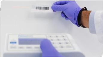
Si la fonction « **Scan** » est activée, **scanner** le code barre en maintenant la pochette de la cuvette à environ 10 cm du scanner et appuyant simultanément sur la touche « **SCAN** ».
