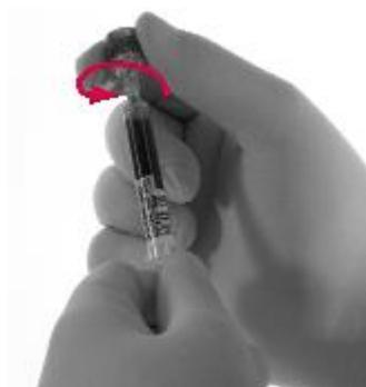
**1.** Mettre en place le bouchon ventilé en tournant d'un quart de tour
